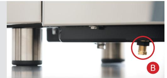
9. Sollte eine Justierung des Pumpendrucks erforderlich sein, so kann diese vom Fachmann über die Einstellschraube unter der Maschine (siehe Abb. B) durchgeführt werden. Bitte für den Verschlussring einen 14 mm Schraubenschlüssel und für die Schraube selbst einen 10 mm Schraubenschlüssel verwenden.
